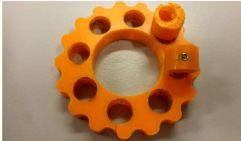
Rys. 1. Zdjęcie uszkodzonych części reduktora w pierwszej wersji Fig. 1. Image of the broken elements in the first version of the reducer
