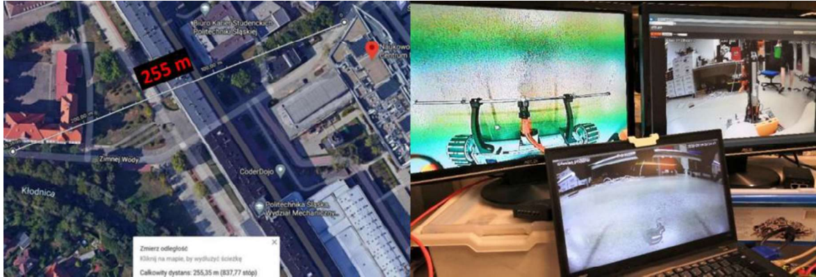
Rys. 2. Maksymalny zasięg komunikacji robota oraz widok z 3 kamer zamontowanych na robocie
