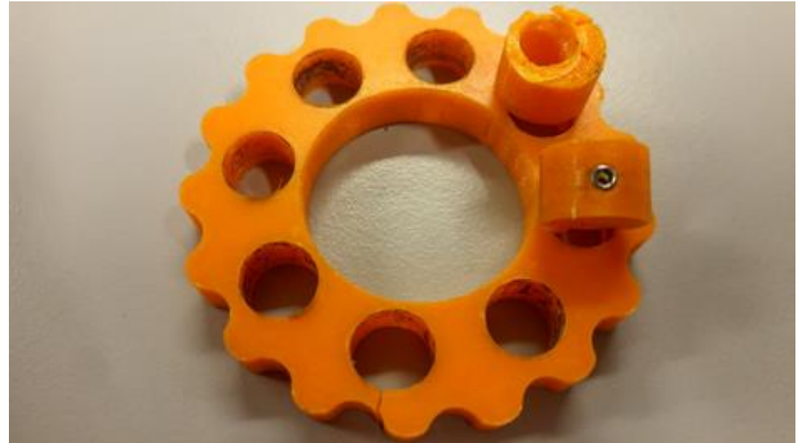
Rys. 2 Zdjęcie pękniętego koła zębatego cykloidalnego oraz ściętego wału mimośrodowego
