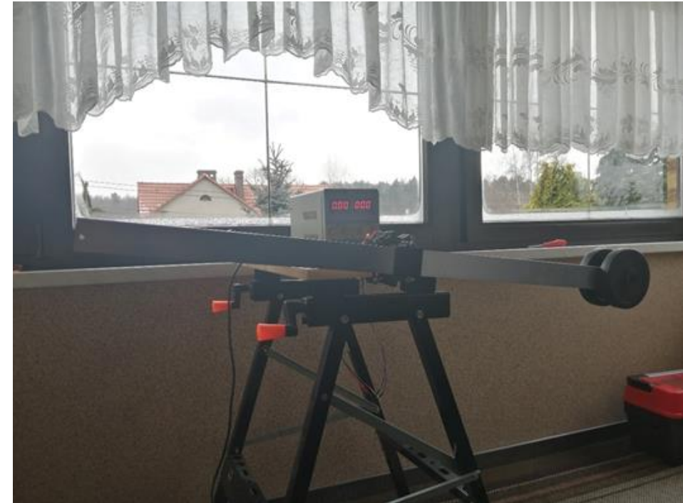
Rys. 20 Stanowisko do badania eksperymentalnego eksploatacji serwonapędu
