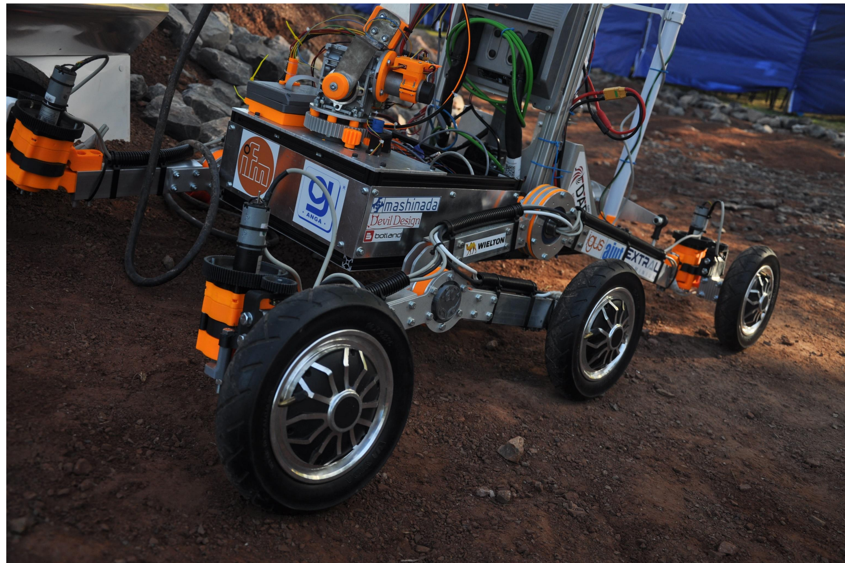
Rys. 10. Phoenix II. Podwozie rocker-boogie
