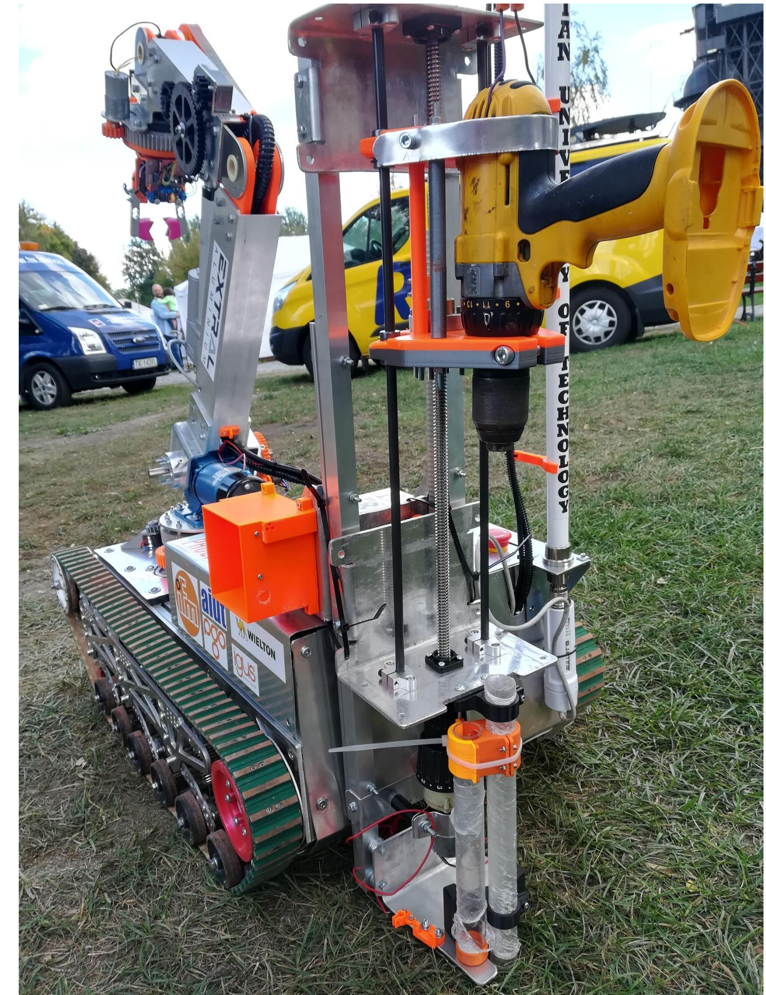
Rys. 7. Phoenix I: układ pobierający próbki głębokościowe
