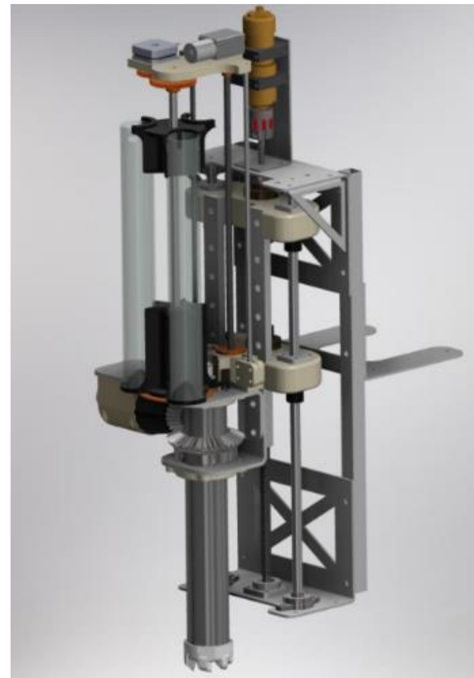
Rys. 14. Wizualizacja modelu CAD układu pobierającego próbkę
