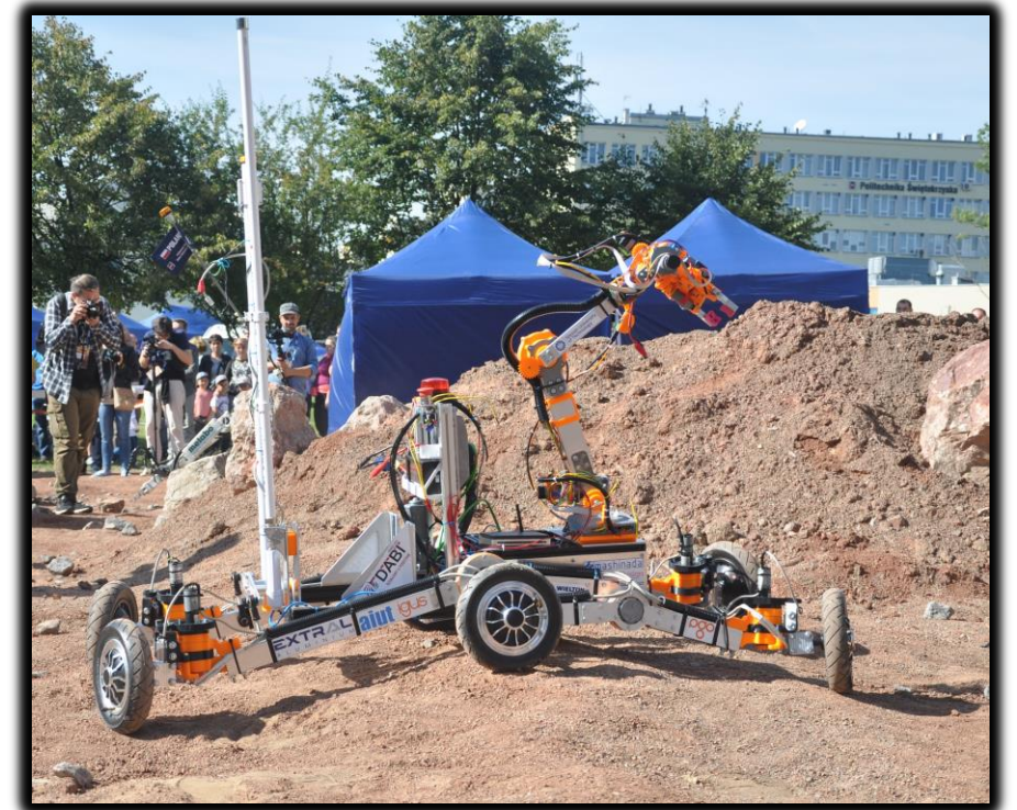
Rys. 4. Phoenix II ze skręconymi osiami i zawieszeniem rocker-boogie [3]
