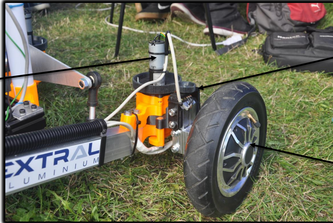
Rys. 8. Oś skrętna oraz silnik napędowy
